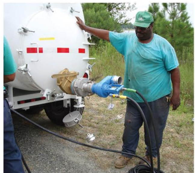
Bomba de transferencia hidráulica
