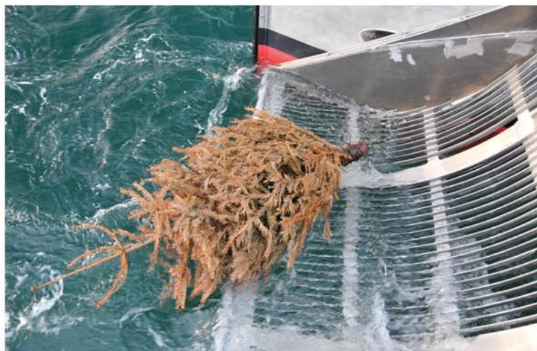
Un poderoso cucharón hidráulico para la recuperación de basura también se puede usar como malla antes de la recuperación de aceite.
