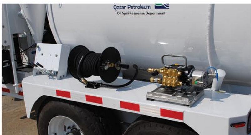
Bomba de agua de alta presión alimentada por tanque de lastre
