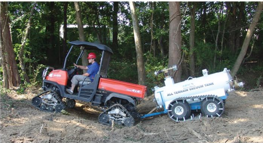
Tanque de vacío todo terreno remolcado por el vehículo todo terreno, ATV
