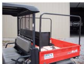
Barandas de la plataforma
